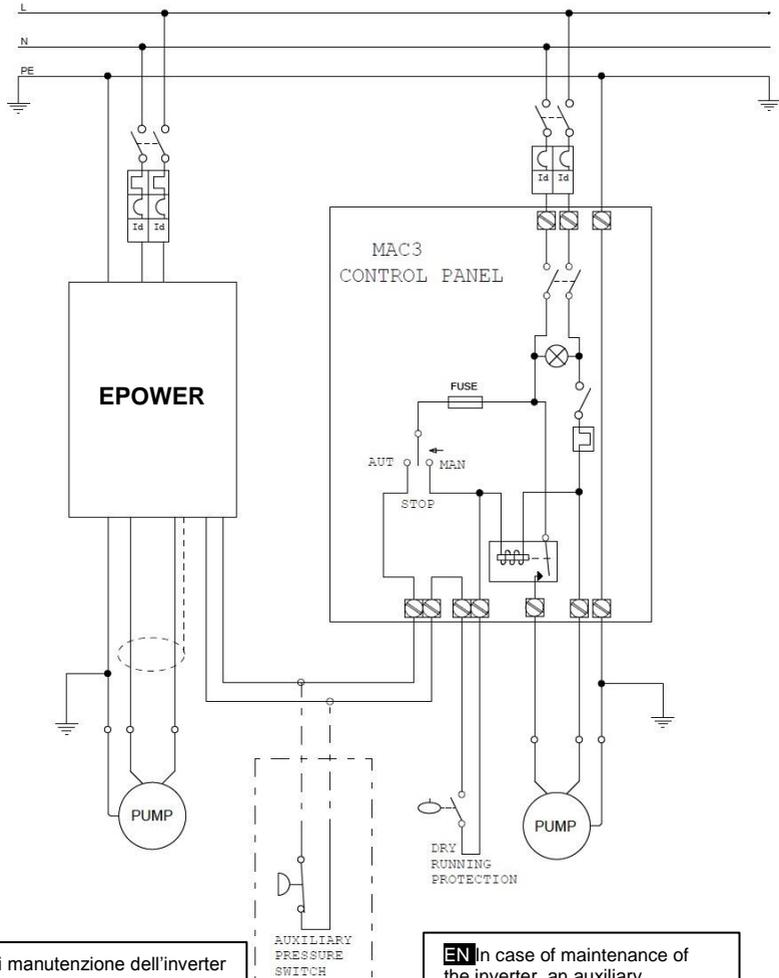
In caso di manutenzione dell'inverter può essere connesso un pressostato ausiliario che permette di garantire continuità di servizio all'impianto per mezzo della pompa on-off. Si consiglia di prevedere in tal caso l'uso di un vaso d'espansione correttamente dimensionato.
