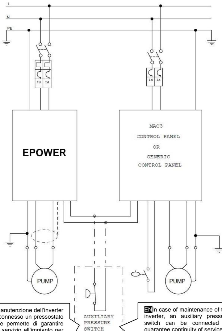
In caso di manutenzione dell'inverter può essere connesso un pressostato ausiliario che permette di garantire continuità di servizio all'impianto per mezzo della pompa on-off. Si consiglia di prevedere in tal caso l'uso di un vaso d'espansione correttamente dimensionato.
